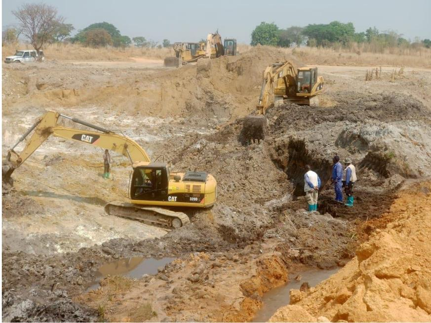
**Figura 13- Exploração do cascalho no depósito de lezíria em Catumba Projecto Mungo**
